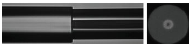
空心光子晶体光纤的切割端面图以及和 SMF-28e 光纤的熔接
