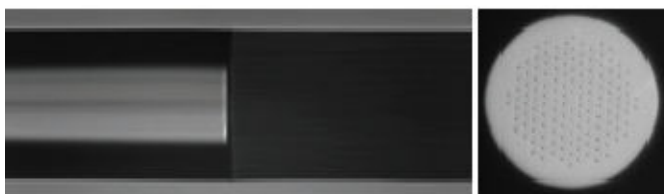
光子晶体光纤的切割端面图以及和 SMF-28e 光纤的熔接
